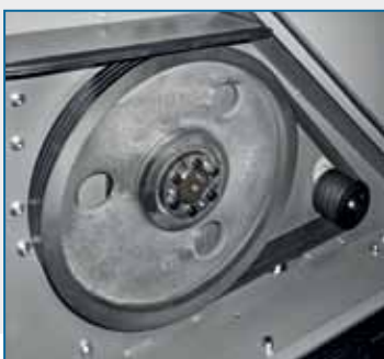
Expansionsstopfen zur Befestigung der Antriebsscheibe und des Schwungrads Standard-Riemenscheibe für erhöhte Schwungkraft
