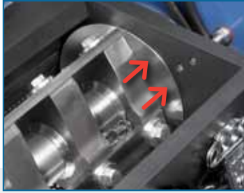
Drehscheiben fest am Rotor befestigt, mit Randscheiben
